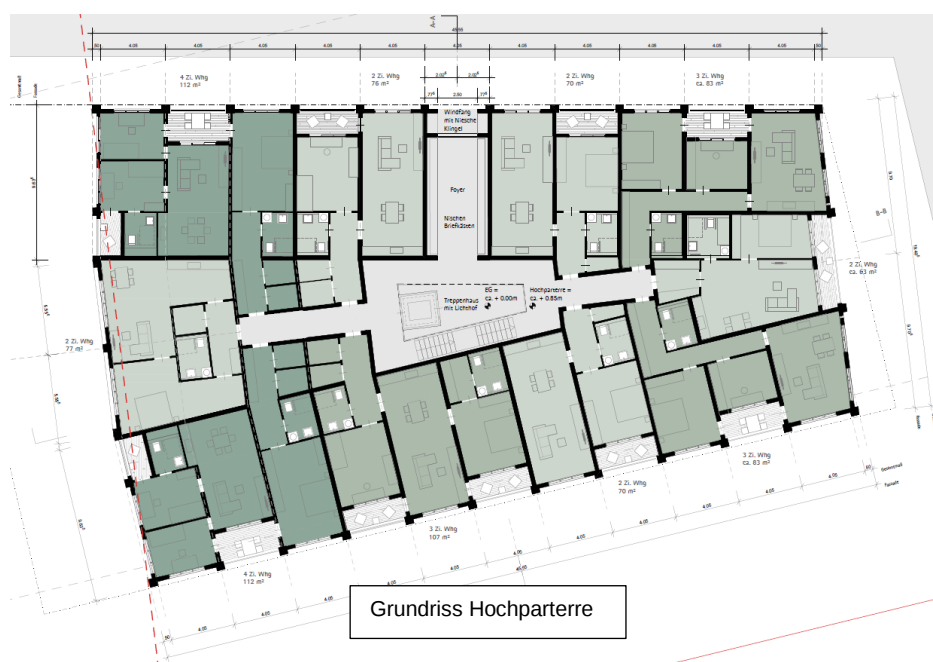
Bild 3-6 Grundriss Hochparterre, bearbeiteter Auszug aus der Unterlage [D 1]
